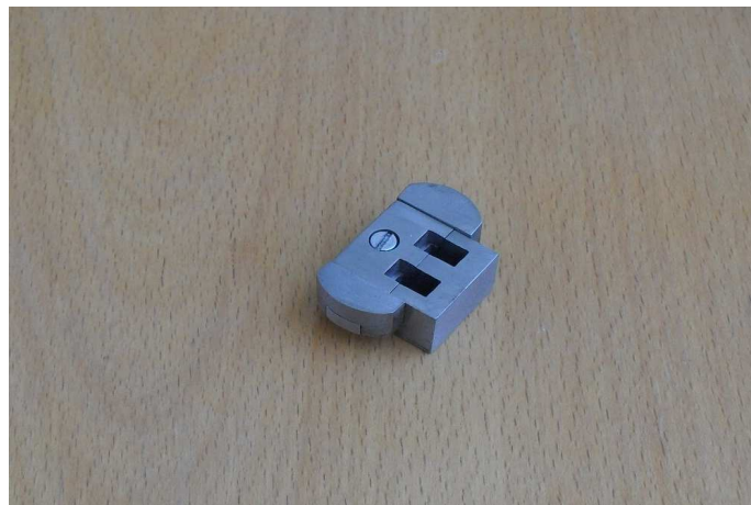
Praktická část oboru Puškař: Základna dalekohledu
